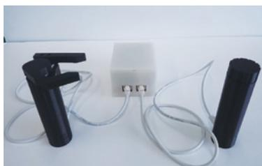
■1軸モーターで2本の指を同時に動かして対象物を掴みます。
