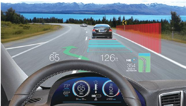
拡張現実(AR)対応のヘッド・アップ・ディスプレイにDLPテクノロジーを使うと、明るく、高輝度、視野角度の広い表示と同時に、仮想画像との距離を広げるフレキシビリティも実現し、ドライバーの自然な視線に表示することができます。
