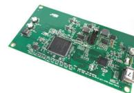
【FPGA版車内LCDドライバー】
