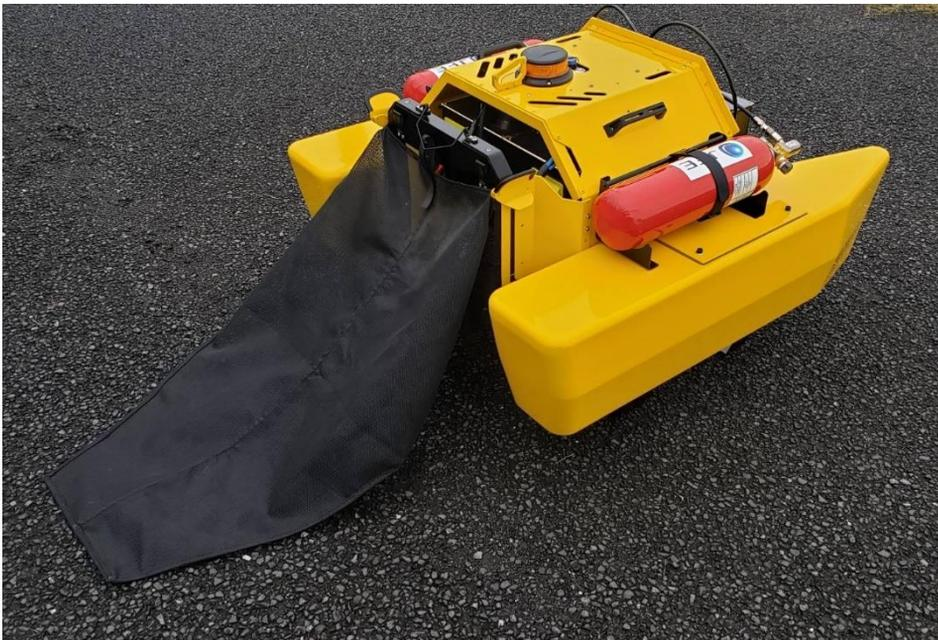
■水上ゴミ回収ドローンに使われているSpectronik社の水素燃料電池、Protiumシリーズ
